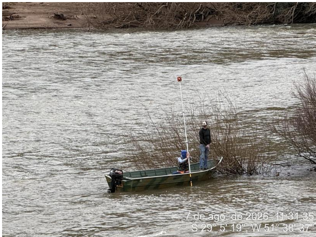
Figura 31 - Realização da batimetria no rio das Antas
