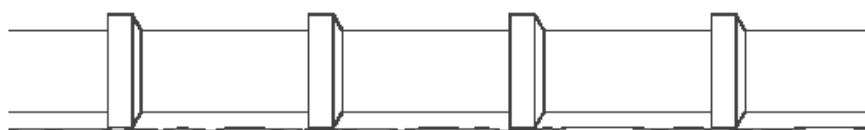
Incorreto (assentamento sobre as bolsas)
