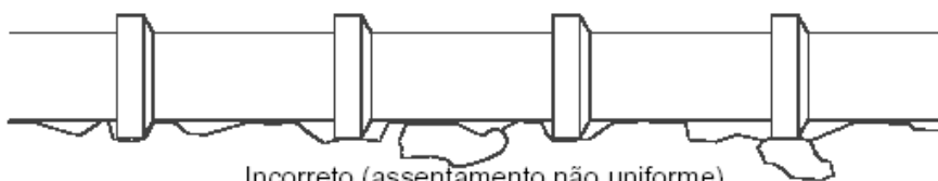
Incorreto (assentamento não uniforme)
