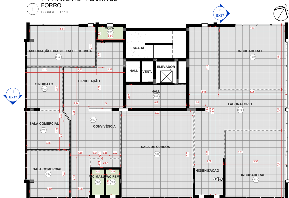
3º PAVIMENTO - PLANTA DE FORRO ESCALA 1:100
