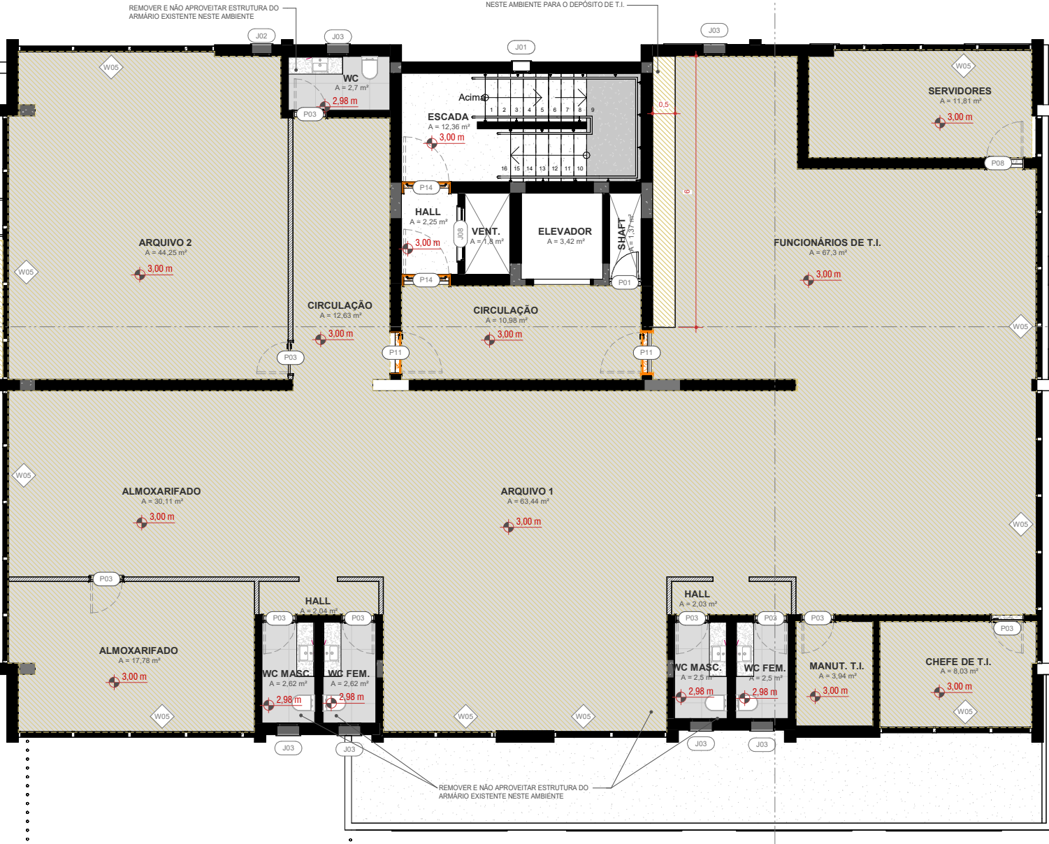
1 PLANTA BAIXA 2º PAVIMENTO - DEMOLIR ESCALA 1:75
