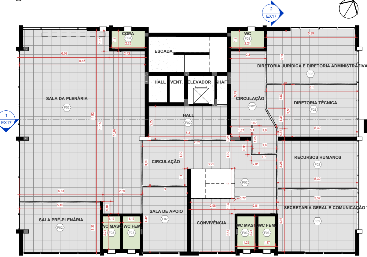
5º PAVIMENTO - PLANTA DE FORRO ESCALA 1:100
