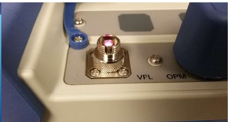
Na foto: O feixe do Localizador Visual de Falhas (VFL) ilumina curvas, emendas e falhas em fibras ópticas, com alcance efetivo de até 10 km.
