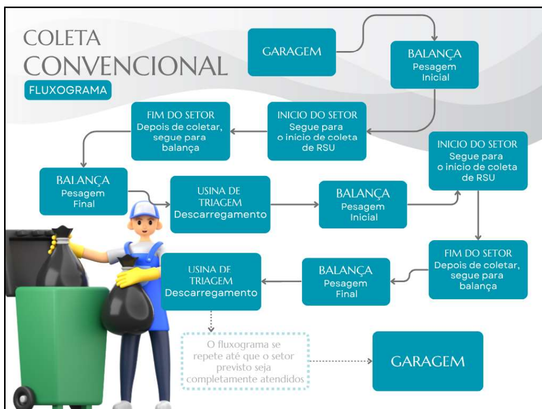
Figura XVII: Fluxograma do processo de coleta convencional.
