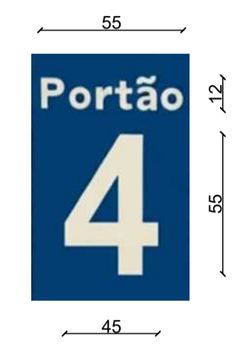
DETAILHE 01 - MEDIDAS DOS LETREIROS DE INDICAÇÃO DOS PORTÕES SEM ESCALA
