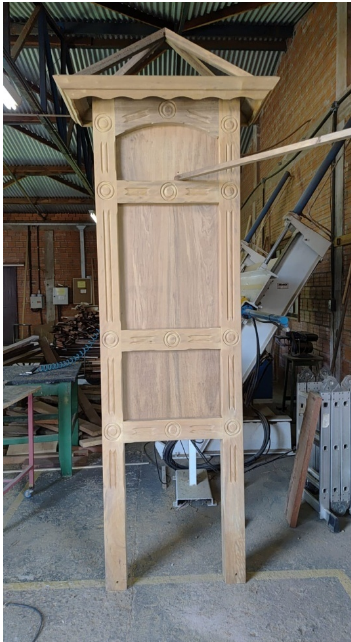
Figura 16 - Estrutura em madeira Itaúba para fixação de placa e pinturas russas.
