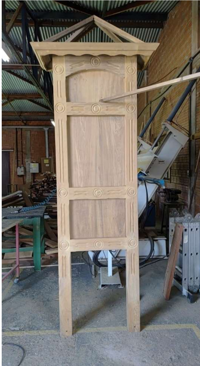
Figura 13 - Estrutura em madeira Itaúba para fixação de placa e pinturas russas.
