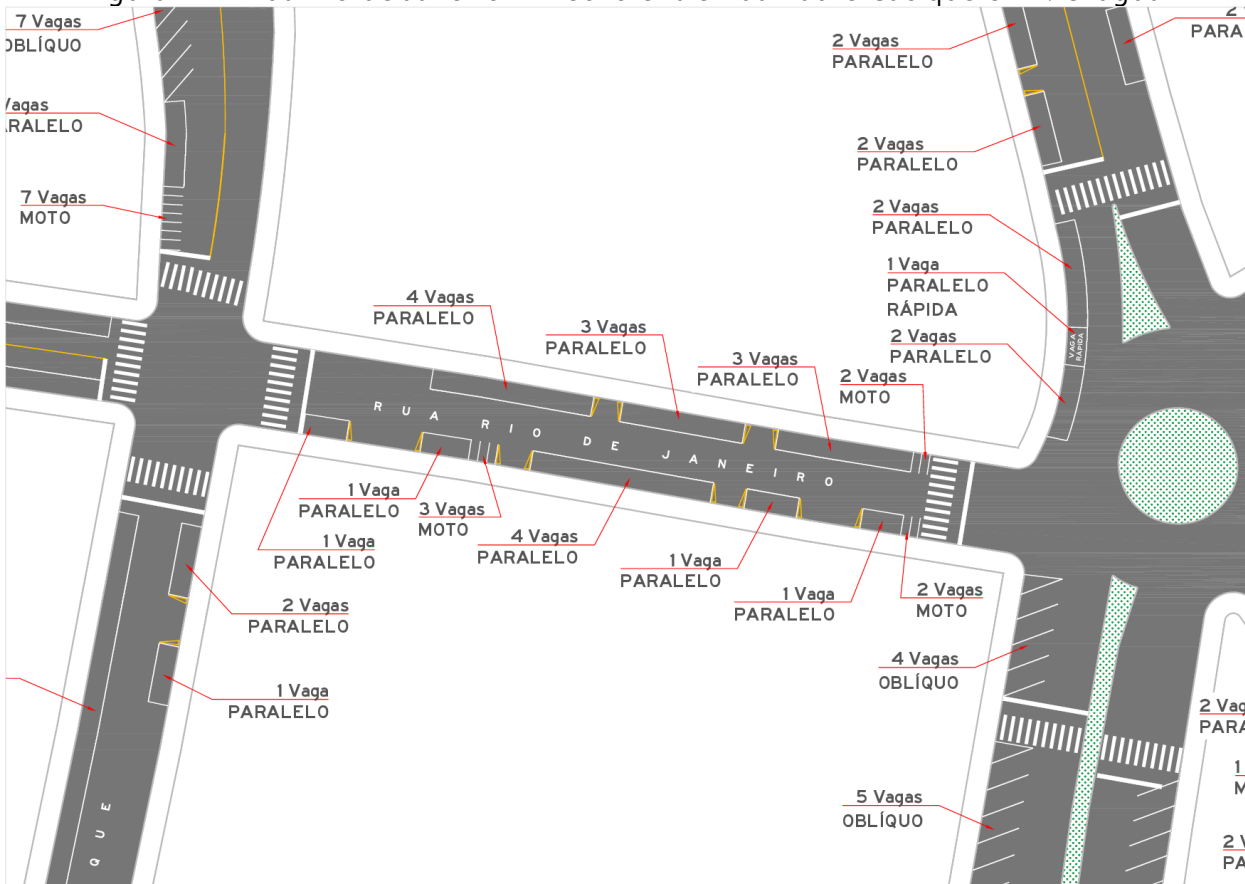
Figura 27 – Rua Rio de Janeiro – Trecho entre Rua Padre Cacique e Av. Uruguai
