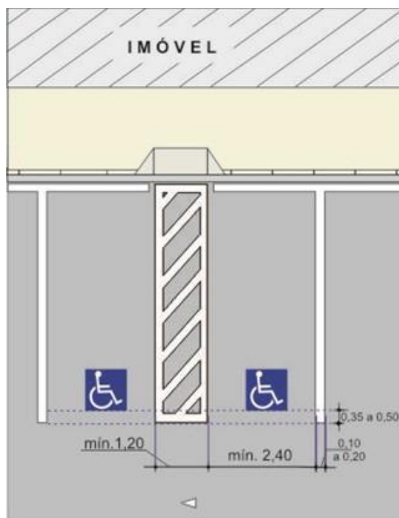
Figura 12 – Exemplo de sinalização horizontal de duas vagas em ângulo com área de proteção
