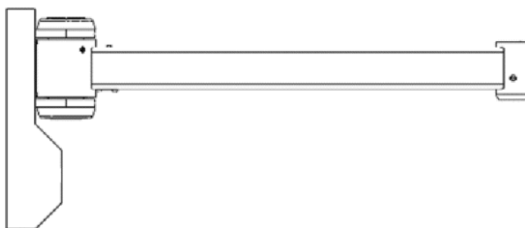
Figura 4 – Exemplo de fixação com 1 braço articulado
