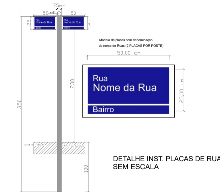
DETALHE INST. PLACAS DE SINALIZAÇÃO SEM ESCALA
