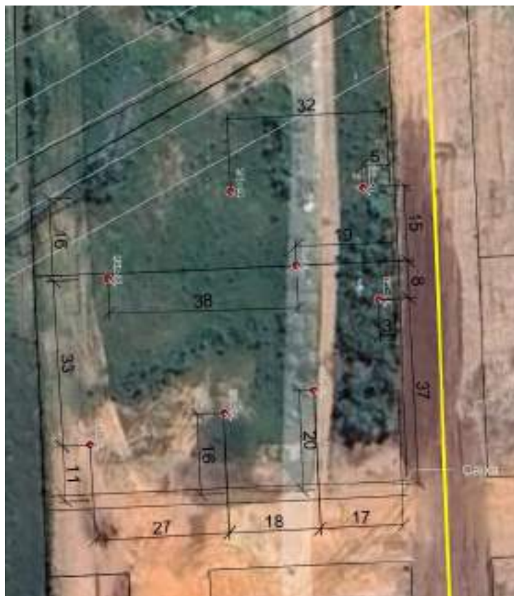
Figura 2 – Planta de locação dos furos de sondagem
