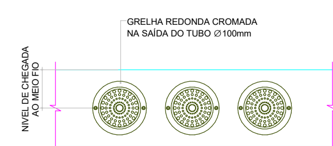
DETALHE-03 SAIDA DO TUBO PVC Ø100 NA SARJETA ESCALA:1/10
