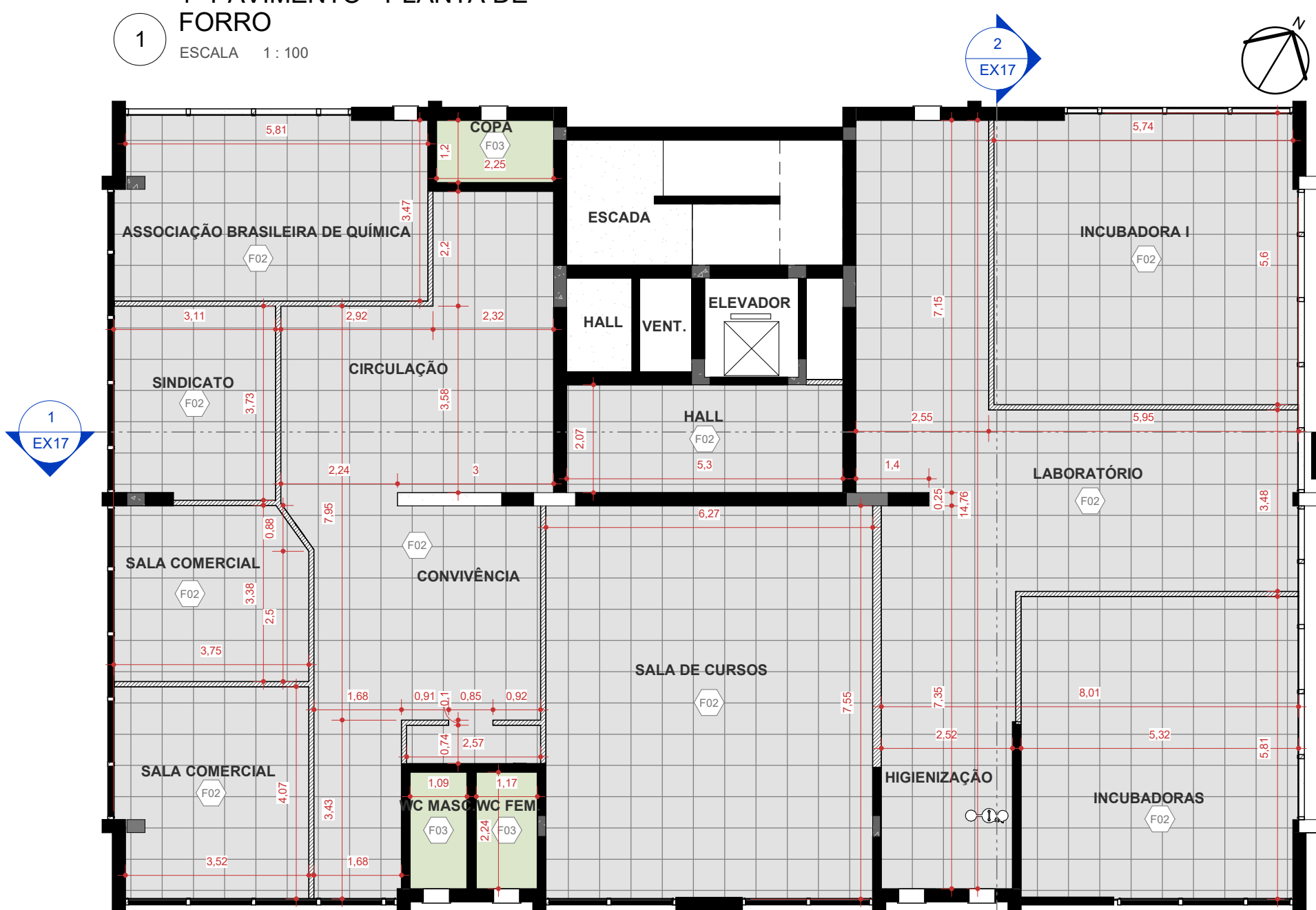
3º PAVIMENTO - PLANTA DE FORRO ESCALA 1:100
