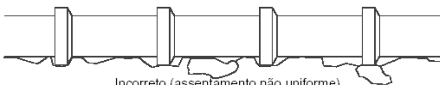
Incorreto (assentamento não uniforme)
