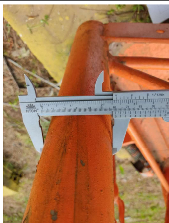
FOTO 3 Montante tubular de Ø60mm
