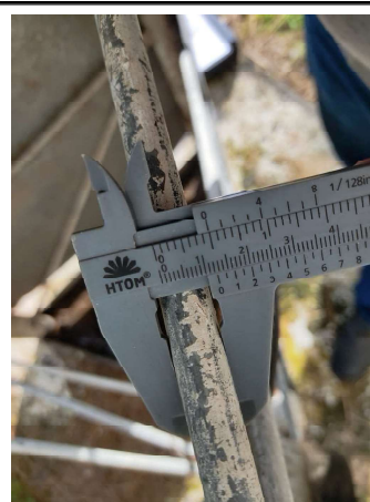
FOTO 12 Travamento ferro mecânico liso de 1/2"
