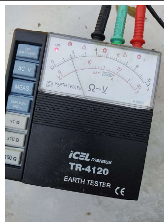
FOTO 6 Medição do aterramento
