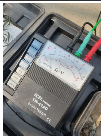
FOTO 12 Medição do aterramento
