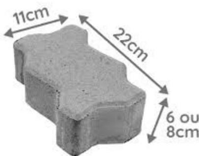
As peças de concreto devem ser do Tipo 1, com formato próximo ao retangular, com relação comprimento/largura igual a dois, que se arranjam entre si nos quatro lados e podem ser assentados em fileiras ou em espinha de peixe.
