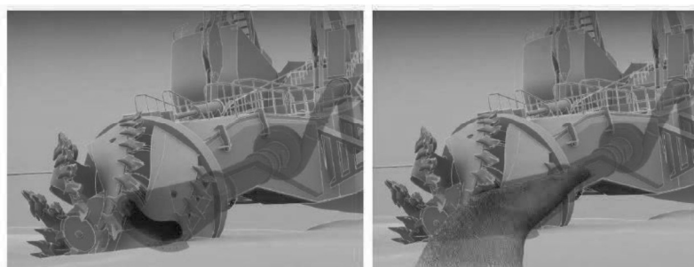
Figura 24 - Detalhe da cabeça de dragagem de uma CSD. Fonte: APEC - Seminar on dredging technologies Junho de 2023.
