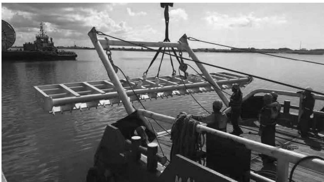
Figura 28 - Exemplo de lâmina niveladora operando no Porto do Rio Grande.
