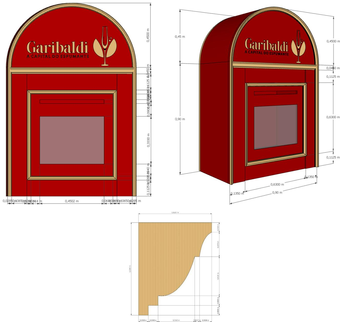
Aquisição, construção e instalação de elemento em formato de caixa de correio, com as seguintes características: estruturação da caixa com caibros e travessas em Pinus tratado 5 x 10cm, fechamento em chapa de MDF 18mm, com acabamento em pintura com esmalte sintético cor vermelho. Painel frontal em acrílico transparente, com sistema abre e fecha, para
