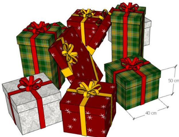
Aquisição e instalação de 14 (quatorze) caixas confeccionadas em compensado naval 18mm com corte laser em formatos natalinos, medindo 0,40 x 0,40 x 0,50m. Pintura com esmalte sintético brilho cores dourado e vermelho.
