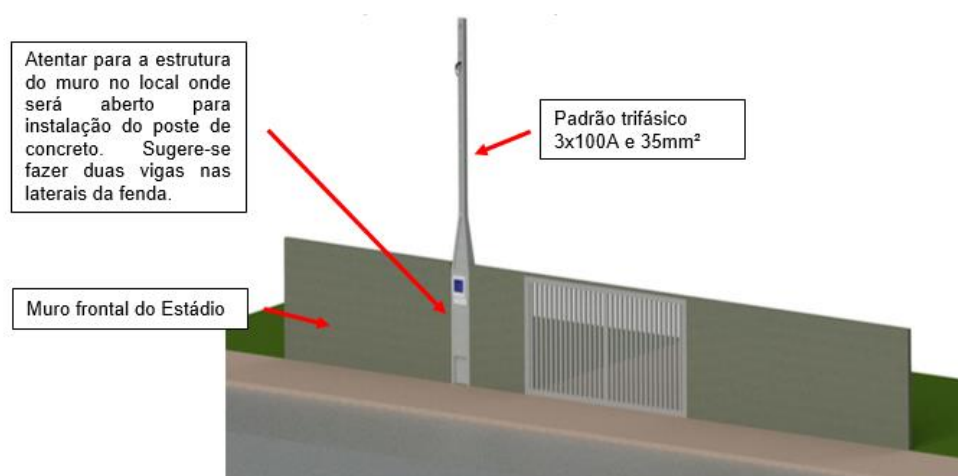
Figura 1 – Padrão de entrada trifásico instalado em poste de concreto com caixa de medição e proteção incorporada
