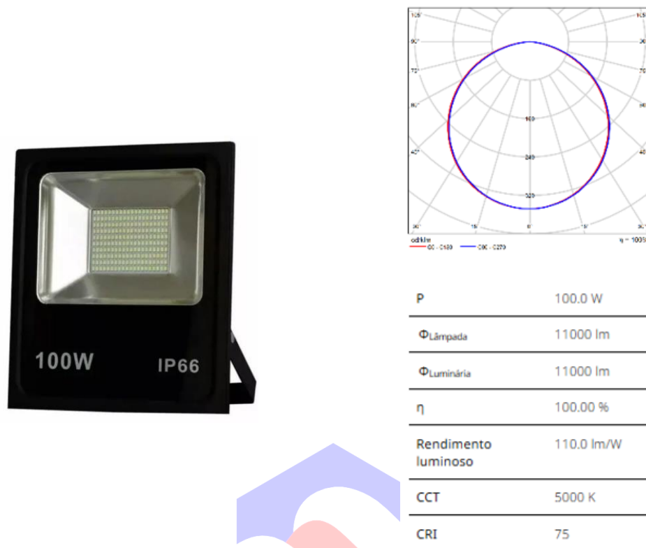
Figura 10 – Especificações Refletor LED 100W
