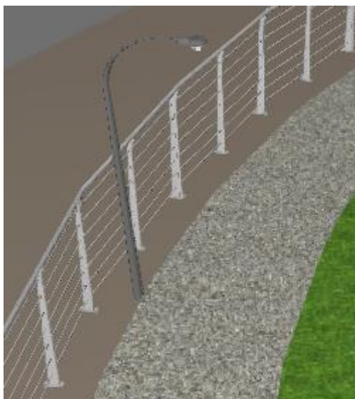
Figura 7 – Instalação Luminária tipo pública 100W
