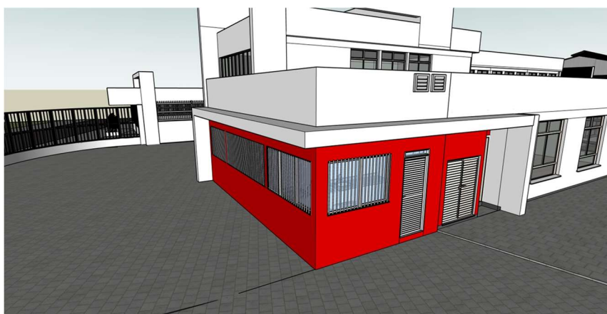
Figura 12: Fechamento dos exaustores na platibanda
