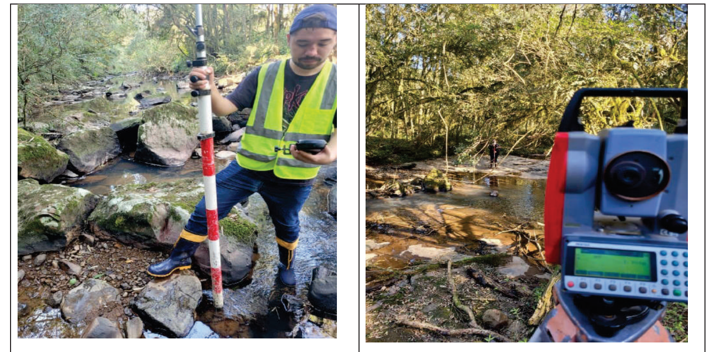
Imagem 11 – Execução de batimetria
