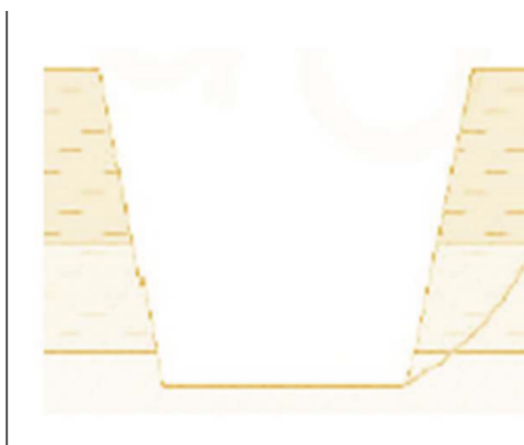
Figura 2- ilustração da inclinação das paredes da área escavada
