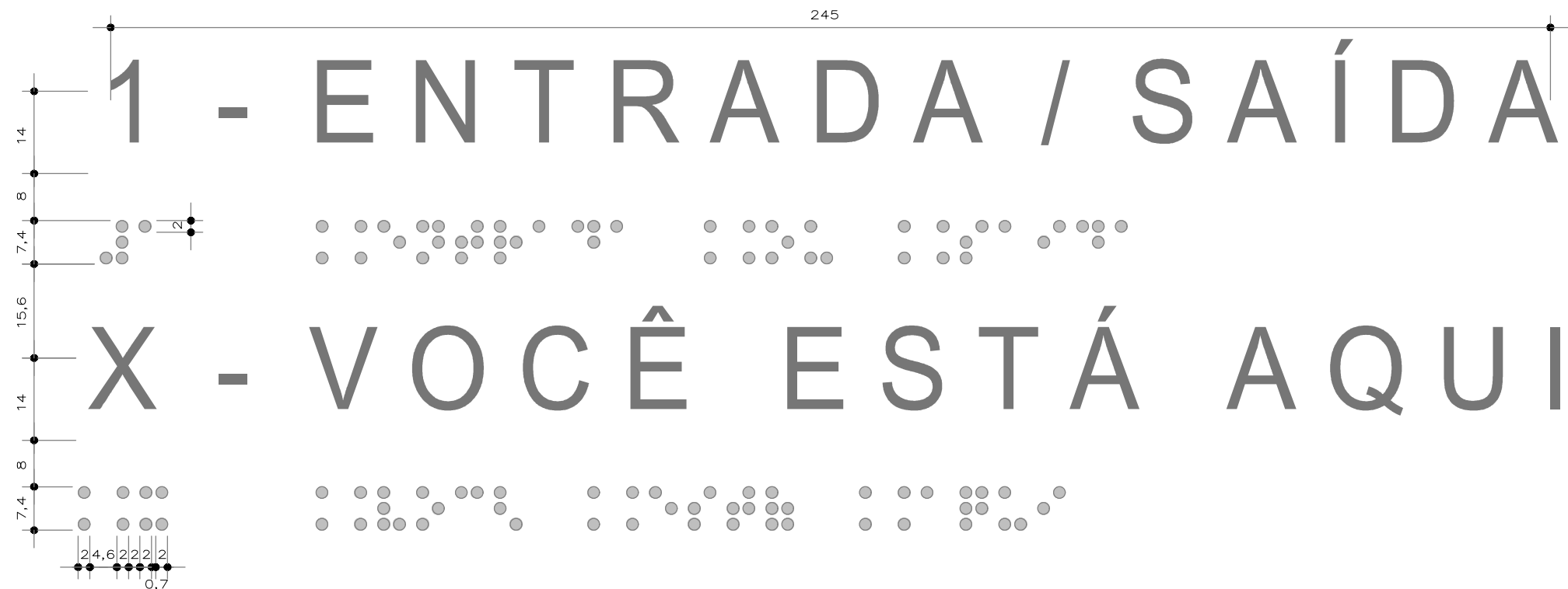
MAPA TÁTIL DETALHE DAS FONTES E BRAILLE MEDIDAS EM mm — ESC. — 1:1
