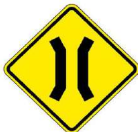
A-22 – Ponte estreita Adverte ao condutor do veículo da existência, adiante, de ponte ou viaduto com largura inferior a da via.
