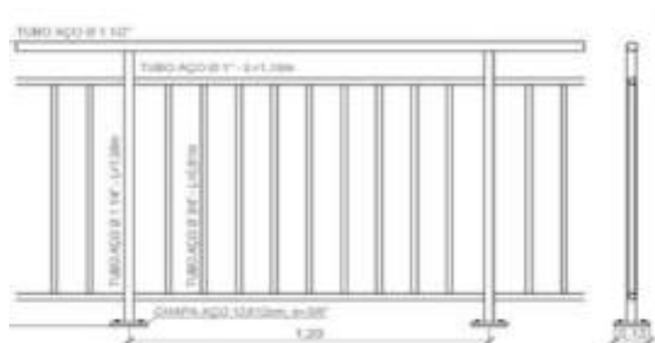
Croqui esquemático para confecção do guarda-corpo
