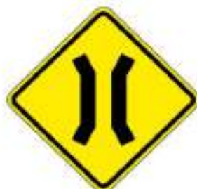
A-22 – Ponte estreita Adverte ao condutor do veículo da existência, adiante, de ponte ou viaduto com largura inferior à da via.
