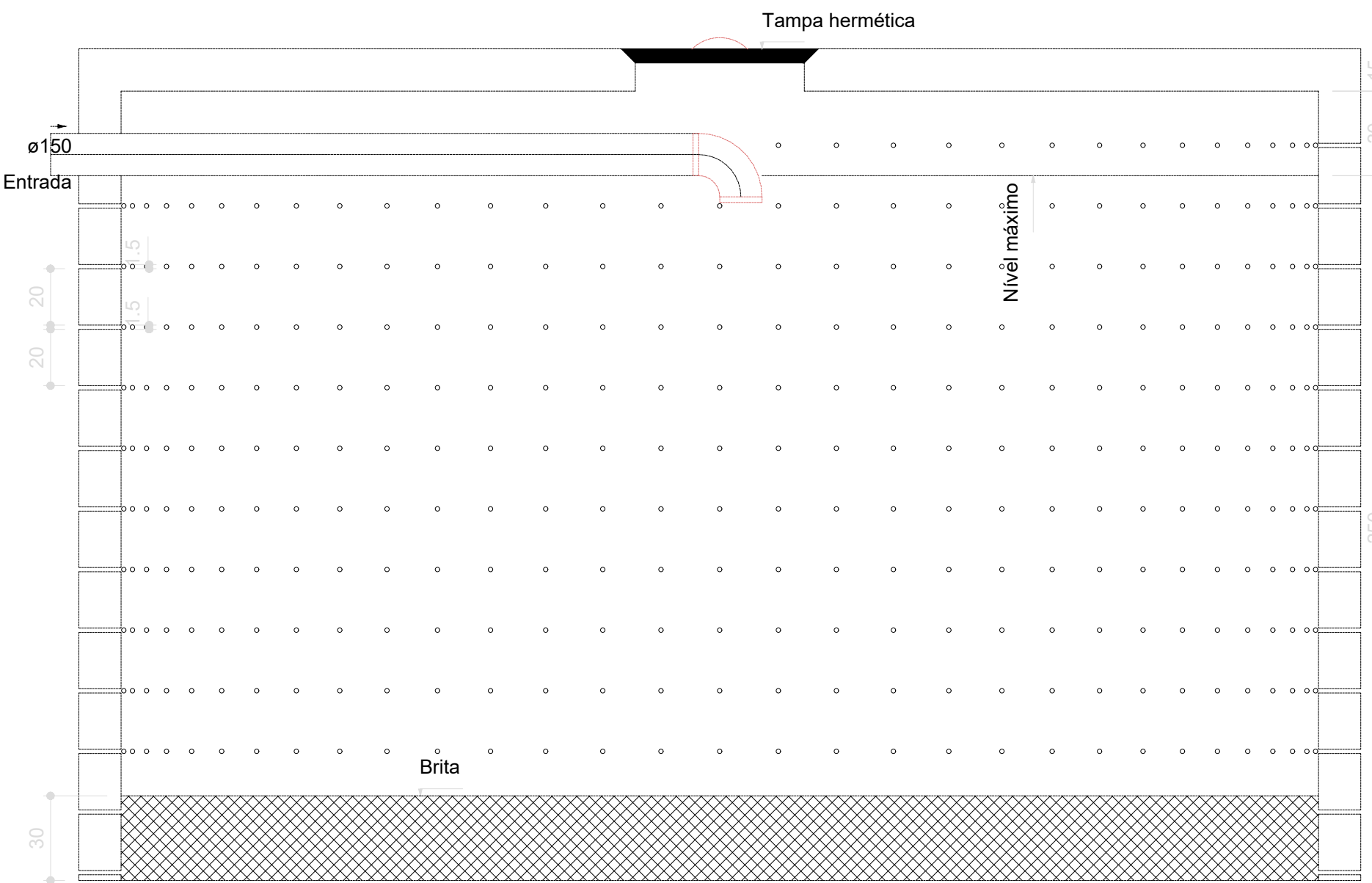
Sumidouro - TÉRREO Corte 1 - ESC. 1:25
