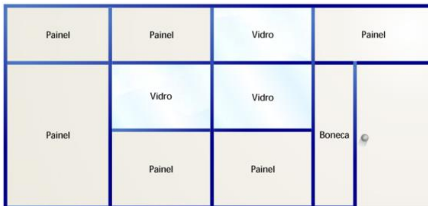
Figura 01. Componentes estruturais básicos do sistema. Fonte: Manual do sistema de divisórias Divilux. Disponível em: https://www.eucatex.com.br/divisorias/
