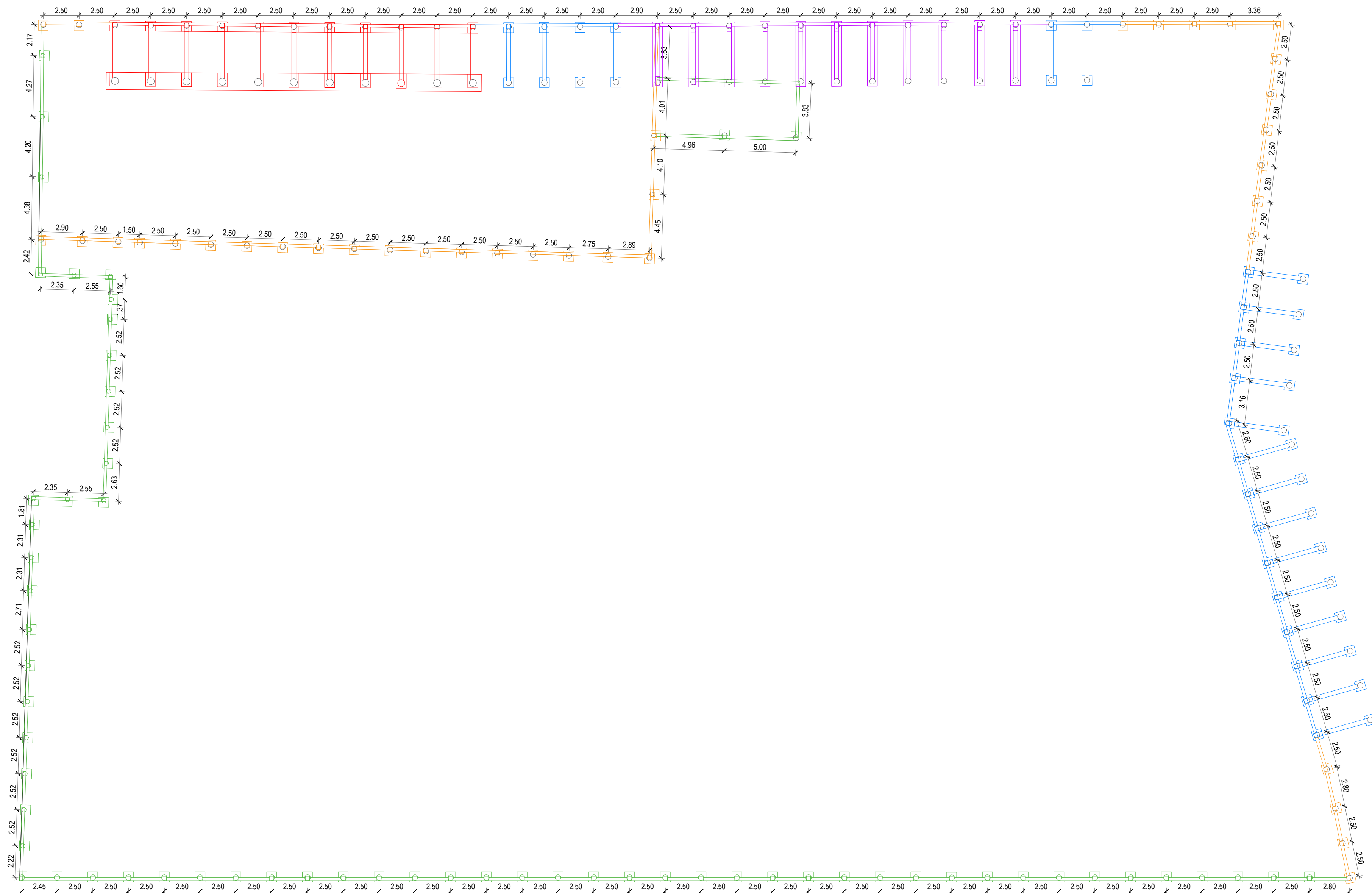
Planta baixa - muro de contenção Escala 1/200
