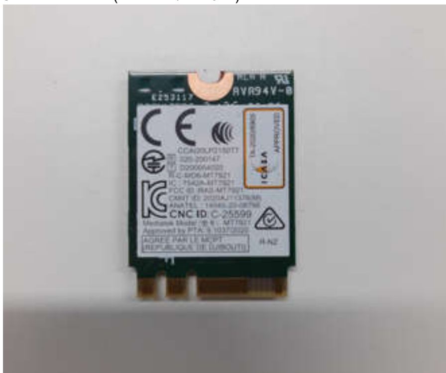
(14) EUT Photo WLAN (Mediatek/MT7921)
