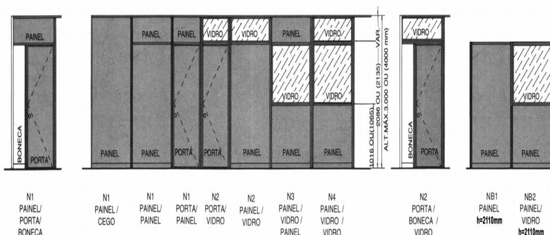
c) Os painéis cegos e portas serão de chapas duras de fibras de madeira prensada com acabamento em pintura à base d'água, com secagem ultravioleta;
