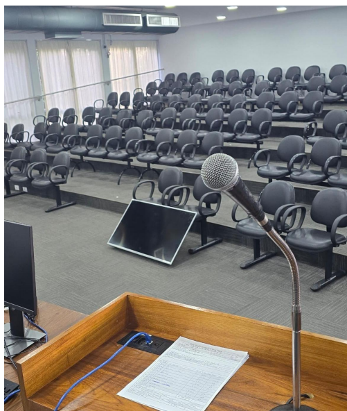
Imagem 06 - Representação da solução de retorno de imagem proposto em suporte para tv de chão em "doghouse" (os assentos estão apenas segurando a tv, não ficando assentos no entorno)
