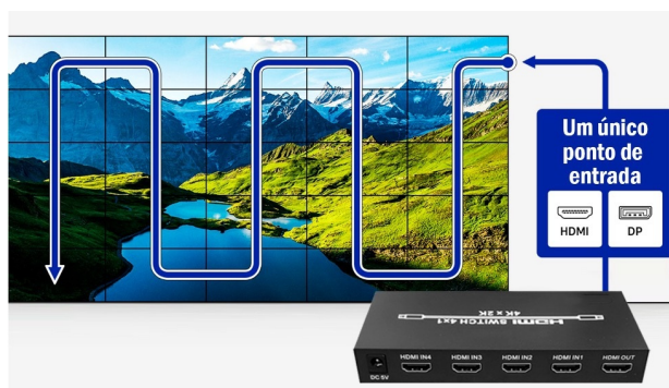
Imagem 2 - Funcionamento do vídeo wall
