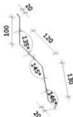
Todos os encontros de telhas com paredes receberão rufos metálicos. Um bordo será embutido na alvenaria, e o outro recobrirá, com bastante folga, a interseção das telhas com a parede. Os rufos deverão recobrir as telhas e se estender verticalmente pela platibanda, conforme especificação e detalhamento de projeto. Quando for o caso estes deverão ser embutidos nas alvenarias.
