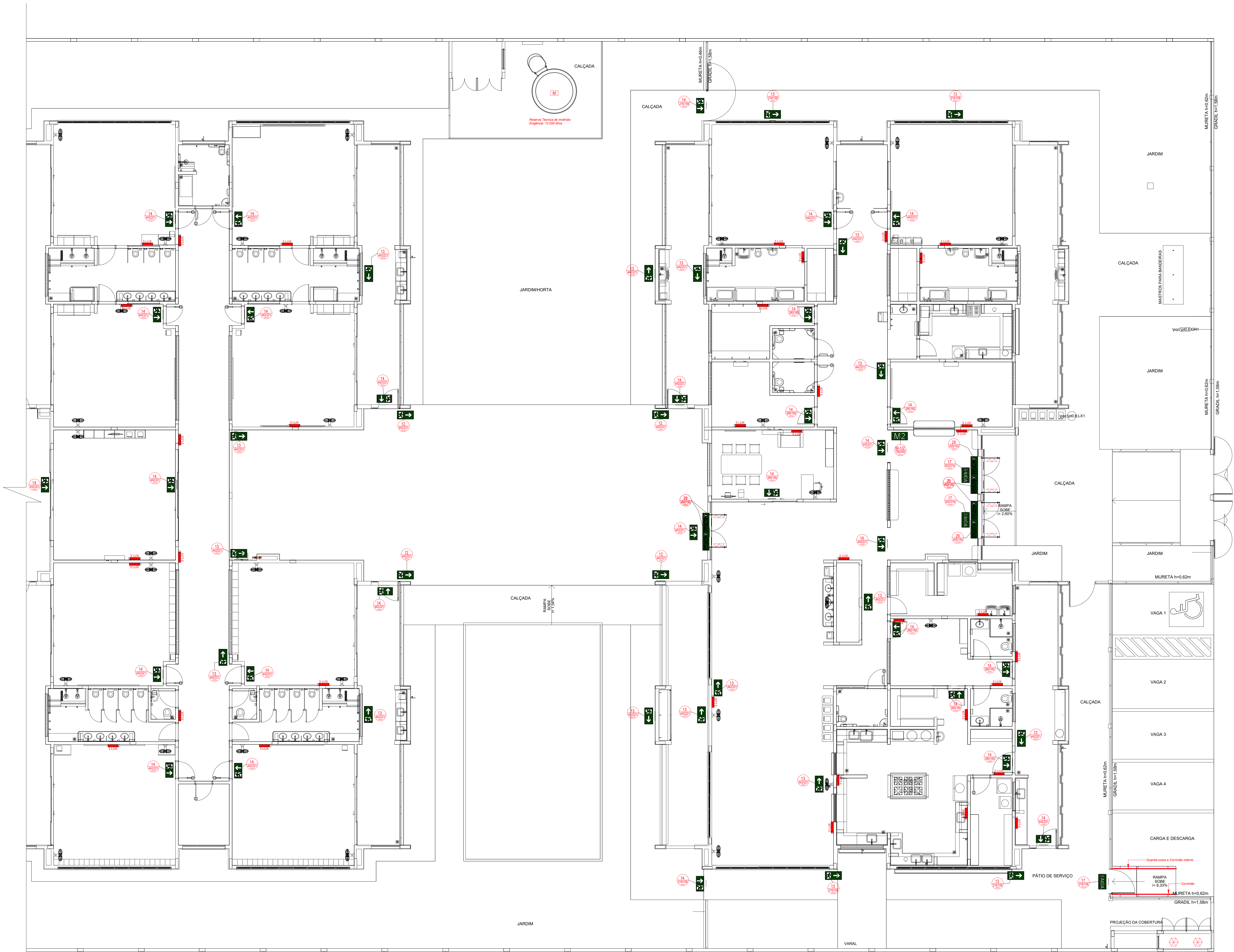
1 PLANTA BAIXA - SINALIZAÇÃO E ILUMINAÇÃO ESCALA 1/75
