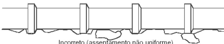
Incorreto (assentamento não uniforme)
