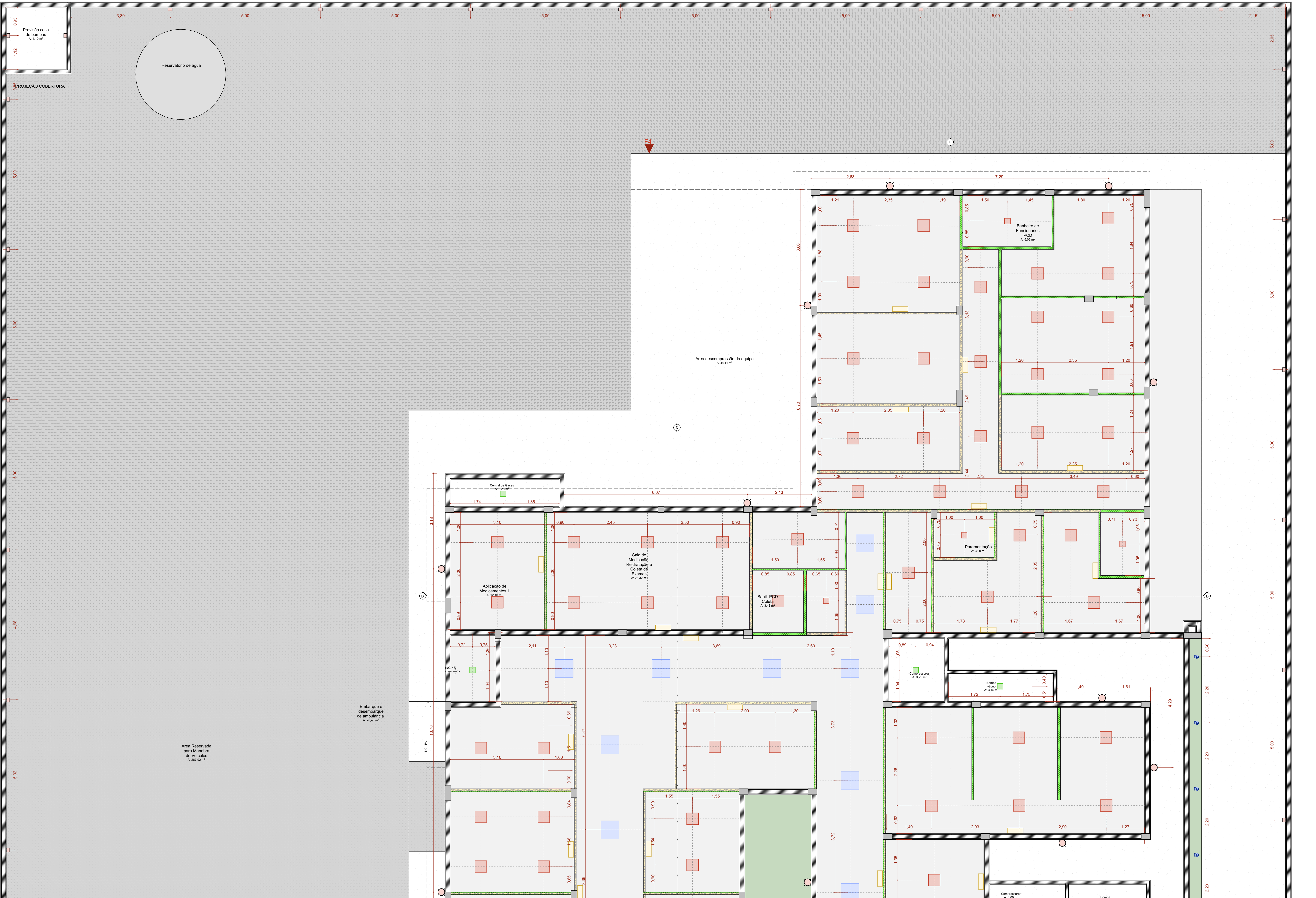
PLANTA FORRO E LUMINOTÉCNICO Escala: 1:50
