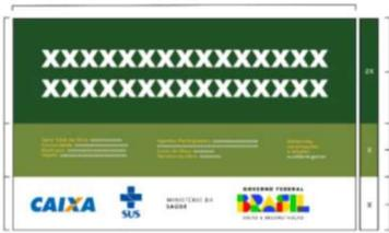
Placa de obra em Chapas Planas Metálicas Galvanizadas; seguindo as dimensões mínimas exigidas pelo órgão financiador. As informações deverão estar em material plástico (poliestireno), para adesivação nas placas. Conforme o recomendado no Manual de Uso da Marca do Governo Federal. Imagem ilustrativa.
