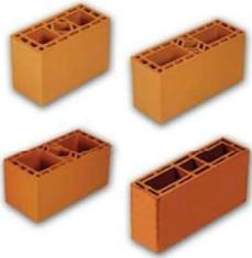
Alvenarias de vedação em blocos vazados cerâmicos na dimensão de 14x19x39cm e 09x19x39cm, executadas através de argamassa preparada em betoneira. A espessura das juntas não deve ultrapassar a 15 mm.
