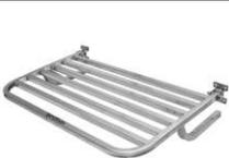
Banco articulado nos banheiros adaptados, com estrutura em aço inox, assento em polipropileno na cor branco, fixado na parede com sistema de travamento na vertical, dimensão 70cm x 45cm, com estrutura que suporte até 150kg.
