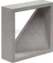
Alvenarias com elementos vazados deverão ser executadas em Cobogó de concreto tipo bandeira de dimensão 30x30x5cm com acabamento polido em ambos os lados, assentados através de argamassa preparada em betoneira. O assentamento será iniciado pela extremidade (cantos), colocando a primeira fiada do cobogó sobre uma camada de argamassa previamente executada.
