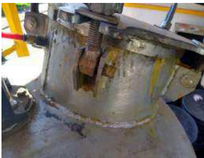
Solda do pescoço de ligação da tampa
