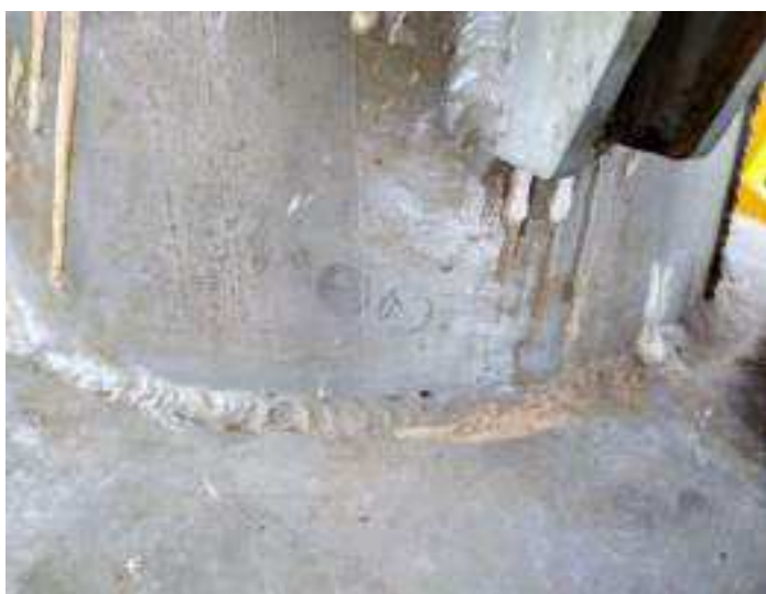
Solda do tampo com o pescoço
