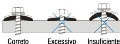
Figura – 7 Recomendação de instalação de profundidade.
