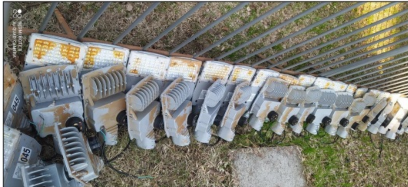
Foto 4: Luminárias danificadas em razão da entrada da água.
