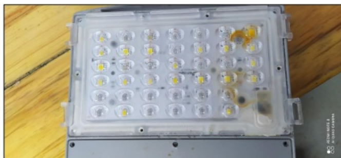
Foto 1: Luminária com água dentro da lente, em contato com os componentes eletrônicos (LEDs).
