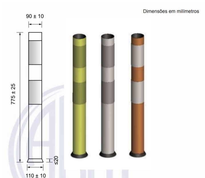
Figura 2 - Representação técnica quanto às dimensões de altura e diâmetro para cilindro delimitador Tipo II
