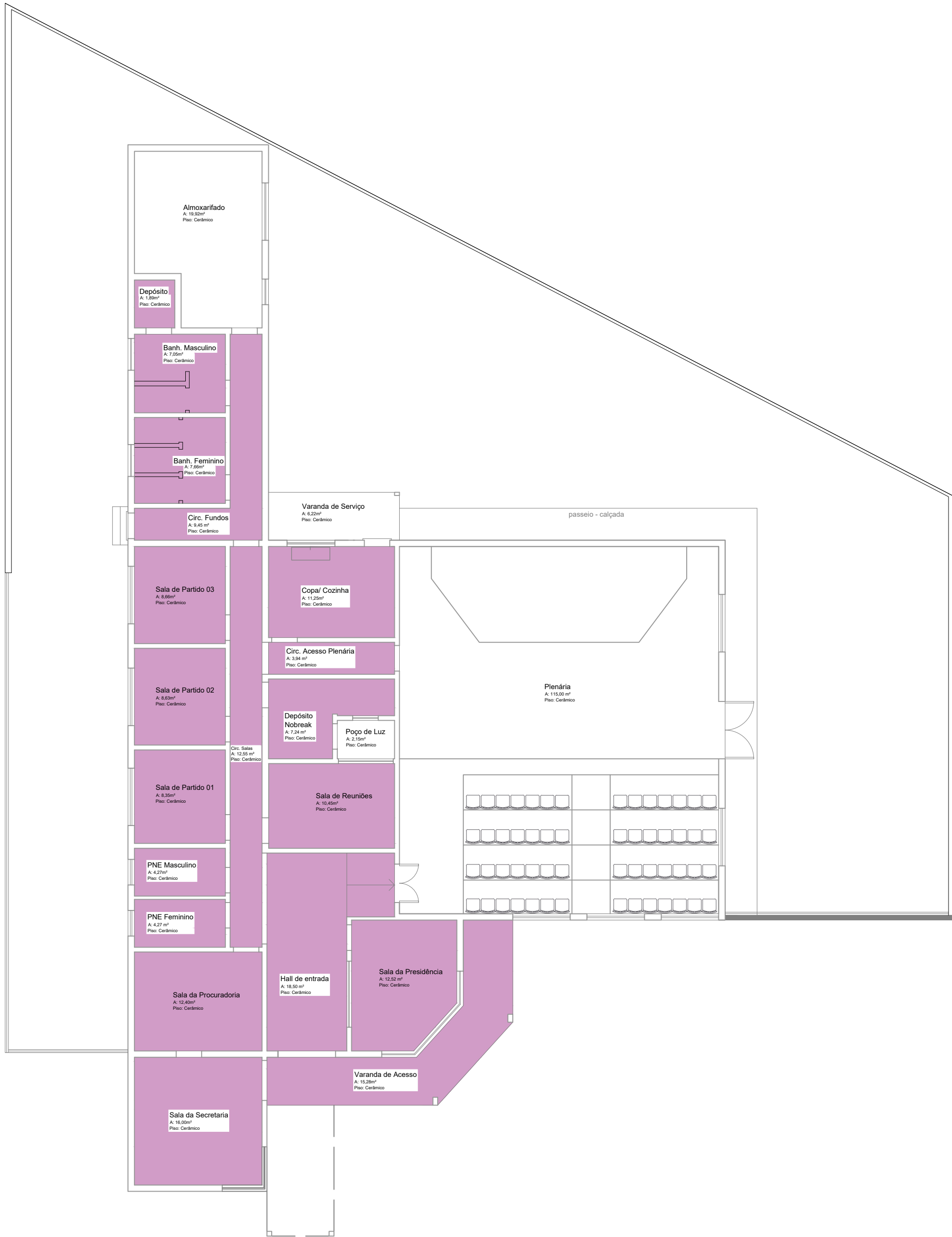
PINTURA TETO - LAJE A: 180,56 m²
