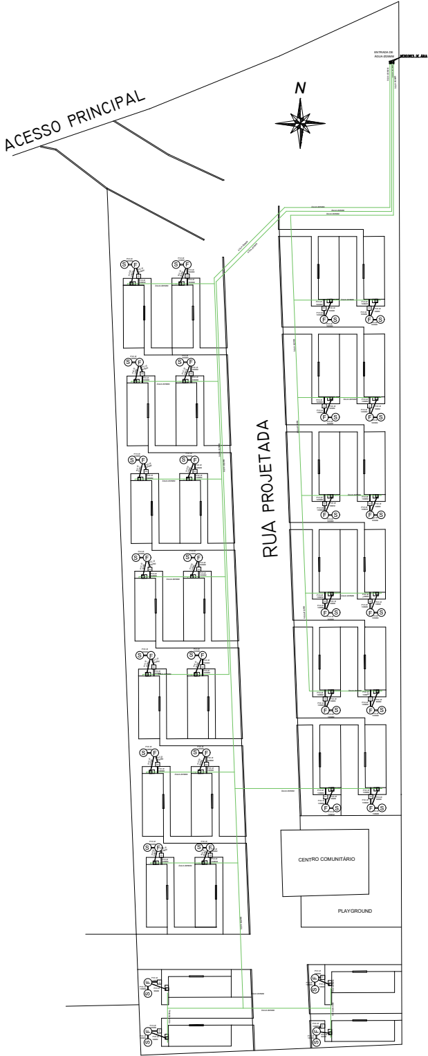
INSTALAÇÃO HIDROSSANITÁRIA ESCALA 1:750
