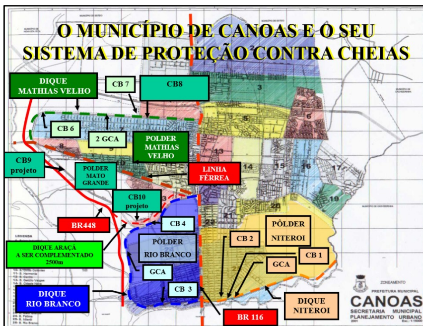
Figura 6: Sistema de proteção contra cheias
