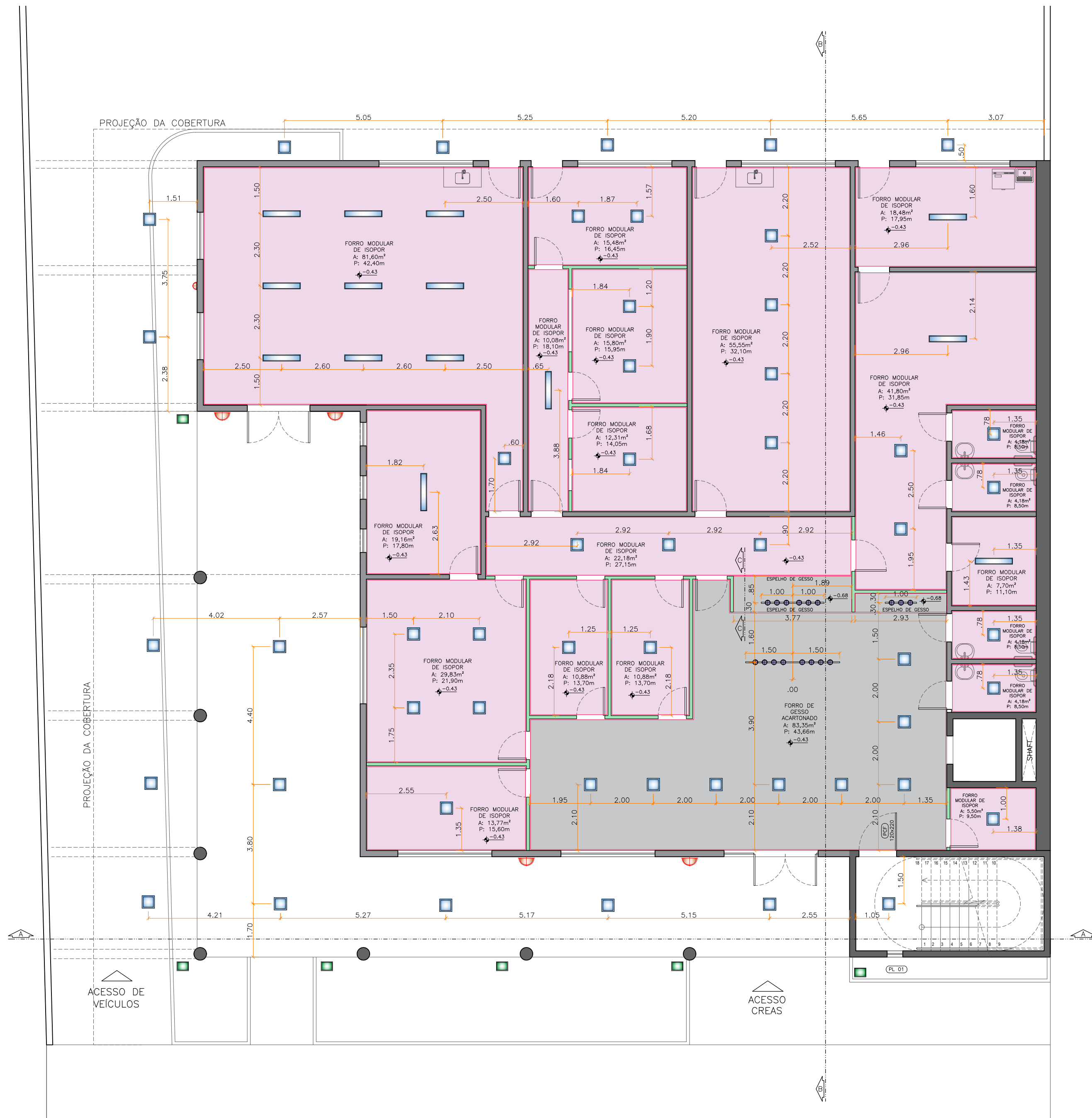
PLANTA BAIXA - FORRO E ILUMINAÇÃO esc 1:100
